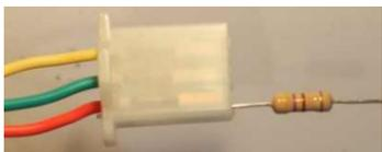
Abbildung 13 Anschluss eines 470Ω Schutzwiderstandes
